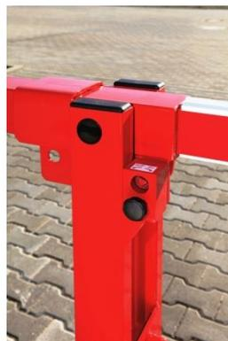
Robuste système de barrière levante manuelle avec contrepoids et poigné d'appui composée d' 1 poteau principal de largeur 100 x 220 mm, à cheviller sur platine dim. 265 x 265 mm, d'1 lisse en aluminium de section XL 90 x 60 mm, longueur au choix et d'1 poteau de repos à cheviller sur platine 200 x 200 mm. Hauteur 1000 mm. Poids de 110 à 175 kg
