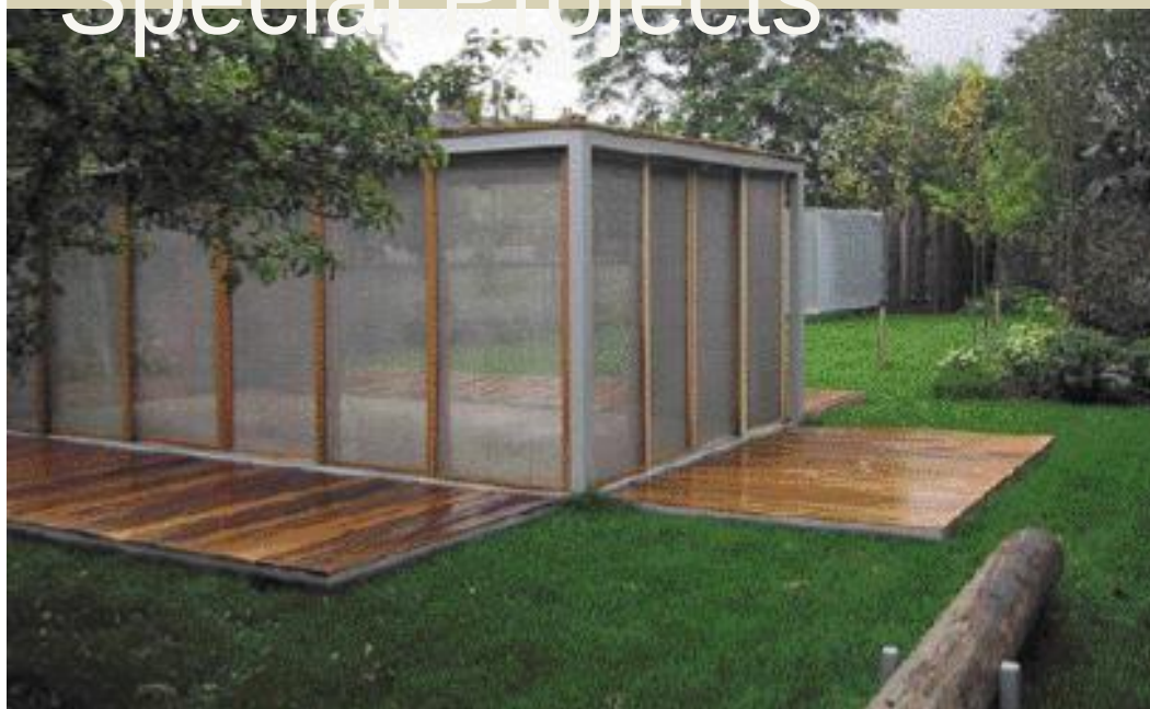
Reveal/conceal est une large construction de parois en cèdre qui se rabattent au sol pour devenir des platelages et avec une deuxième « peau » coulissante ; des écrans de treillis en acier inox.
