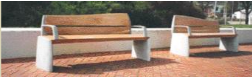
La Millennium promenade à Gosport : assises sur le front de mer, fonte d'aluminium et lames en chêne
