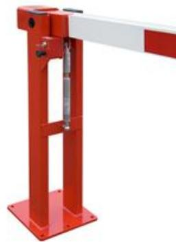
Robuste système de barrière levante manuelle avec système d'assistance par VERIN, composée d' 1 poteau principal de largeur 100 x 220 mm, sur platine dim. 300 x 300 mm, à cheiller au sol, d'1 lisse en aluminium de section XL 90 x 60 mm, longueur au choix et d'1 poteau de repos à cheiller sur platine 200 x 200 mm. Hauteur 1000 mm. Poids de 75 à 135 kg
