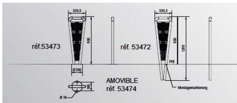
Potelet constitué d'encadrement en arceau tubulaire de diamètre et d'un remplissage intérieur décoratif de treillis soudé sur le tube. Finition des soudures de haute qualité.
